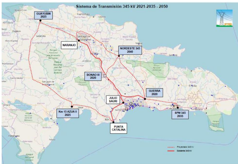
345KV National Transmission System Expansion 2021-2035-2050 Source: Plan de Expansión: Sistema de Transmisión Eléctrico (2021-2035) [45]
